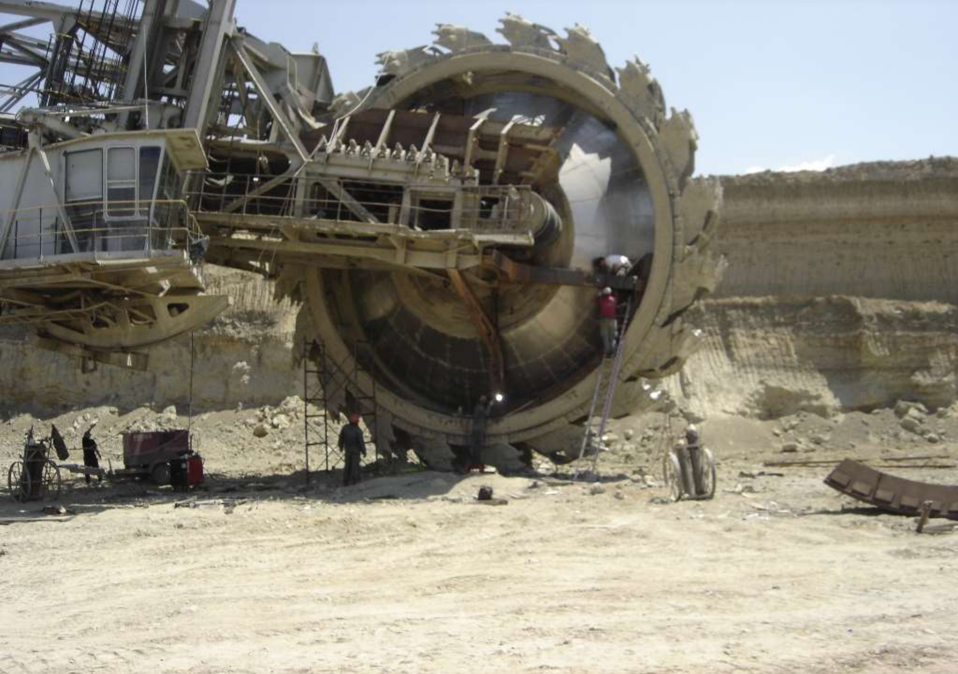
Συντήρηση σε καδοφόρο εκσκαφέα
